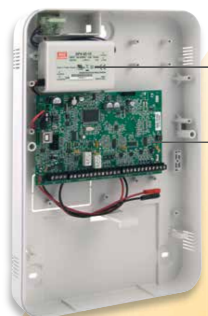
Un apposito spazio è predisposto per il fissaggio del nuovo concentratore radio bidirezionale (DRX66AE). E' sufficiente estrarre il concentratore dal suo box plastico e fissarlo. Il concentratore è dotato di connessione a morsetto per antenna radio 433 Mhz.
