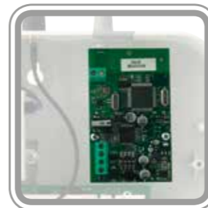
Un apposito spazio è predisposto per il fissaggio del nuovo concentratore radio bidirezionale (DRX66AE). E' sufficiente estrarre il concentratore dal suo box plastico e fissarlo. Il concentratore è dotato di connessione a morsetto per antenna radio 433 Mhz.
