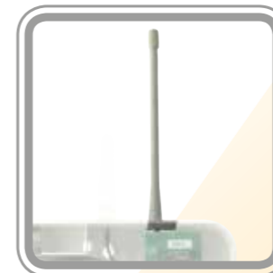
L'antenna radio a stilo (DAN656) si installa facilmente ad incastro sull'armadio e si collega direttamente alla scheda del concentratore radio (DRX66AE). Laddove l'ubicazione della centrale non garantisce un segnale radio sufficiente si può spostare il concentratore all'esterno lungo la linea seriale RS485.
