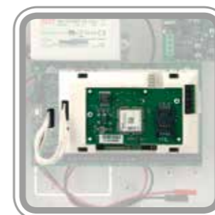
La scheda centrale può ricevere ad innesto il modulo PSTN (DCT62) che a sua volta riceve l'espansione GSM (DCT65).
