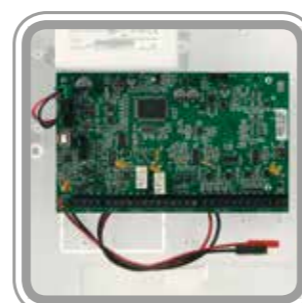
Scheda centrale SYDOM COMPACT. COMPACT 150: 4 zone indipendenti, 8 ingressi programmabili a bordo; 2 uscite programmabili a bordo + 8 su bus; 32 ingressi wireless. COMPACT 250: 6 zone indipendenti, 8 ingressi programmabili a bordo + 24 su bus; 4 uscite programmabili a bordo + 16 su bus; 32 ingressi wireless.
